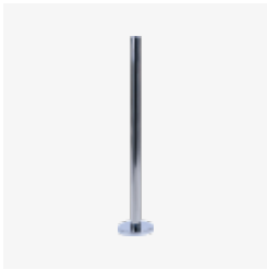
Stützstrebe mit Befestigungsflansch und Flanschabdeckung aus Edelstahl AISI 304. H = 980 mm. Ohne Löcher, mit 2 Löchern, mit 2+2 Löchern im 90°- oder 180°-Winkel, mit 6 Löchern, mit 8 Löchern.
