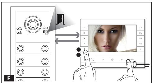
Зеленый светодиодный индикатор мигает. Поднимите трубку абонентского устройства (при наличии) и нажмите одновременно клавиши открывания двери 0— и AUX2 .
