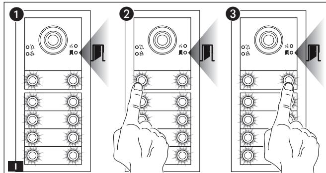
Durante la programmazione delle chiamate **I** ① è possibile regolare l'intensità luminosa e il colore della retroilluminazione dei moduli. Premendo il tasto di chiamata a sinistra si seleziona il colore bianco **I** ② a destra il colore blu **I** ③. Premendo con lo stesso tasto, in modo ciclico, si seleziona uno dei cinque livelli di luminosità (spento, 25%, 50%, 75%, 100%).
