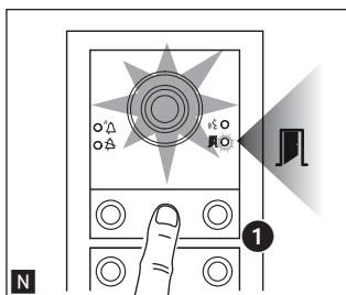
Tramite un tasto di chiamata precedentemente assegnato è possibile incrementare/decrementare l'intensità dell'illuminatore **N**.
