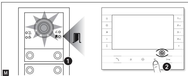
При программировании вызовов **M 1** можно регулировать яркость освещения козырька вызывной панели с любого абонентского устройства.
