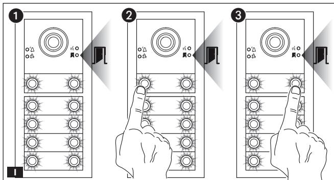
Il est possible, durant la programmation des appels **I** ①, de régler l'intensité lumineuse et la couleur du rétroéclairage des modules. Appuyer sur la touche d'appel à gauche pour sélectionner la couleur blanche **I** ②, à droite la couleur bleue **I** ③.
