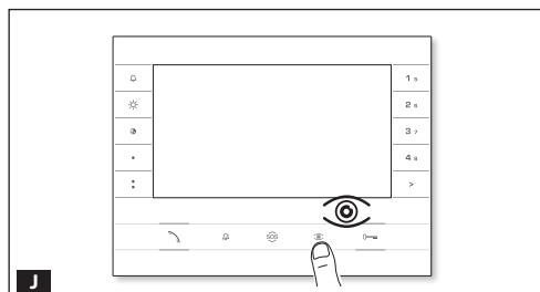
Durante la programmazione delle chiamate è possibile regolare il 'campo visivo' della telecamera da un qualsiasi derivato (con cornetta sollevata, se presente), premendo il tasto 'autoinserimento '. **J**.
