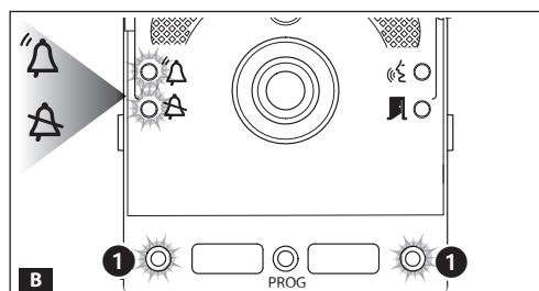
Нажмите первую клавишу вызова на каждом из модулей **C** **D** (см. пункт "Нумерация клавок") и удерживайте до тех пор, пока синий светодиодный индикатор **Δ** и светодиоды клавиш не перестанут мигать.
