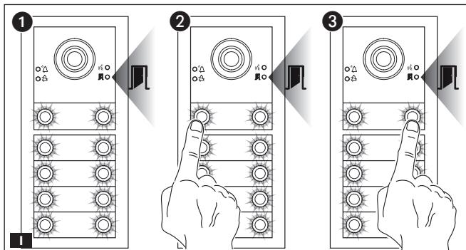
При программировании вызовов **1** можно отрегулировать яркость и цвет подсветки модулей. При нажатии левой клавиши вызова будет выбран белый цвет **1**, при нажатии правой — синий **3**.
