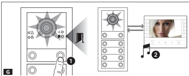
Нажмите на вызывной панели клавишу вызова, которую вы хотите присвоить абонентскому устройству **G 1**: последует звуковой сигнал, сообщающий об успешном занесении в память **G 2**. Завершите вызов и продолжите программирование, повторяя те же действия для всех остальных абонентских устройств.
