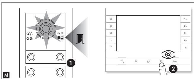
Durante la programmazione delle chiamate **M** ① è possibile regolare l'intensità dell'illuminatore del posto esterno da un qualsiasi derivato.
