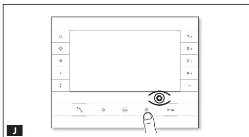
При программировании вызовов можно регулировать "угол обзора" камеры с любого абонентского устройства (при поднятой трубке, если таковая имеется), нажав клавишу "Автоворот" **J**.
