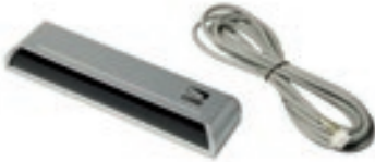
Czujnik podczerwieni i zasięgu regulowanym. Maksymalna wysokość montażu: 3 m. Głębokość detekcji: 0,41 - 1,77 m. Szerokość pola: 3,1 m. MR8003
