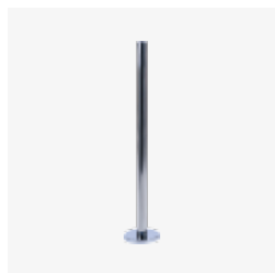
Montant avec bride de fixation et couvre-bride en acier AISI 304 . H = 980 mm . Disponible sans trous, avec 2 trous, avec 2+2 trous à 90° ou 180°, avec 6 trous, avec 8 trous .
