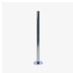
Montante in acciaio zincato con flangia di fissaggio e copriflangia in plastica cromata. H = 980 mm. Disponibile senza fori, con 2 fori, con 2+2 fori a 90° o 180°, con 6 fori, con 8 fori.
