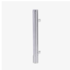
001PSTRV80 Montant en acier AISI 304 . H = 900 mm, Ø 80 mm . Disponible sans pinces, avec 2 pinces, avec 2+2 pinces à 90° ou 180°, avec 6 pinces, avec 8 pinces .
