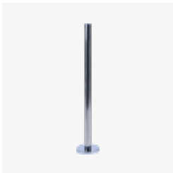
001PSTRVX Montant avec bride de fixation et couvre-bride en acier AISI 304 . H = 980 mm . Disponible sans trous, avec 2 trous, avec 2+2 trous à 90° ou 180°, avec 6 trous, avec 8 trous .
