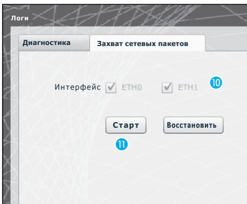
С помощью вкладки **“Захват сетевых пакетов”** можно произвести сбор всех входящих и исходящих от устройства данных (**НО НЕ трафик с одного порта на другой**).
