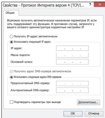
В этом окне поставить галочку напротив "Использовать следующий IP-адрес" и заполнить поля следующим образом:
