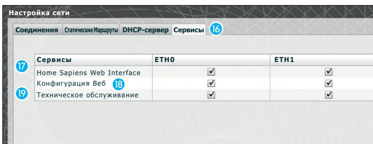
Раздел "Сервисы" (16) доступно, только если конфигурация двух портов "дублированная сеть". Для каждого порта можно подключить или отключить перечисленные ниже услуги:
