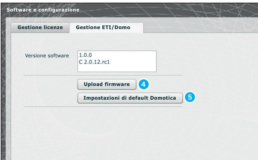
Nella sezione “Gestione ETI/Domo” permette di vedere e aggiornare la versione del software installato.
