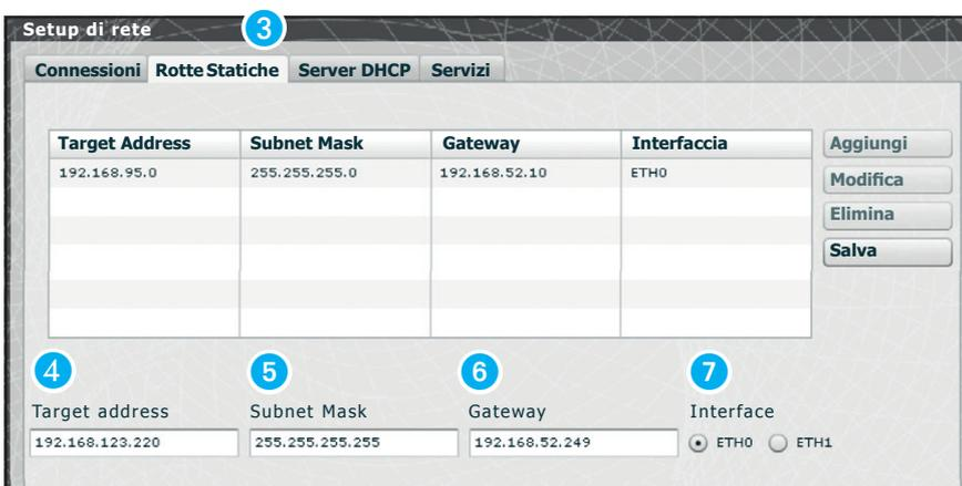
Le **rotte statiche** (3) sono delle regole per trasmettere i pacchetti IP verso reti diverse dalle due sottoreti corrispondenti alle interfacce ETH0 e ETH1. Questa sezione è presente solo in modalità Dual Network.
