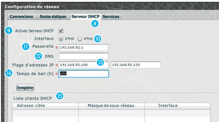
**10 Interface** : permet de choisir l'interface sur laquelle le service doit être activé en cas de configuration à double réseau ; pour une configuration Switch, la seule interface possible est ETH0. Il n'est pas possible d'activer le service sur les deux interfaces.
