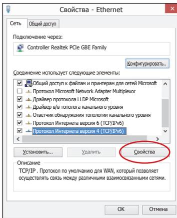
В окне "Состояние Ethernet" выбрать "Свойства"; выделить "Протокол Интернет версия 4 (TCP/IPv6)" кликнуть на "Свойства".
