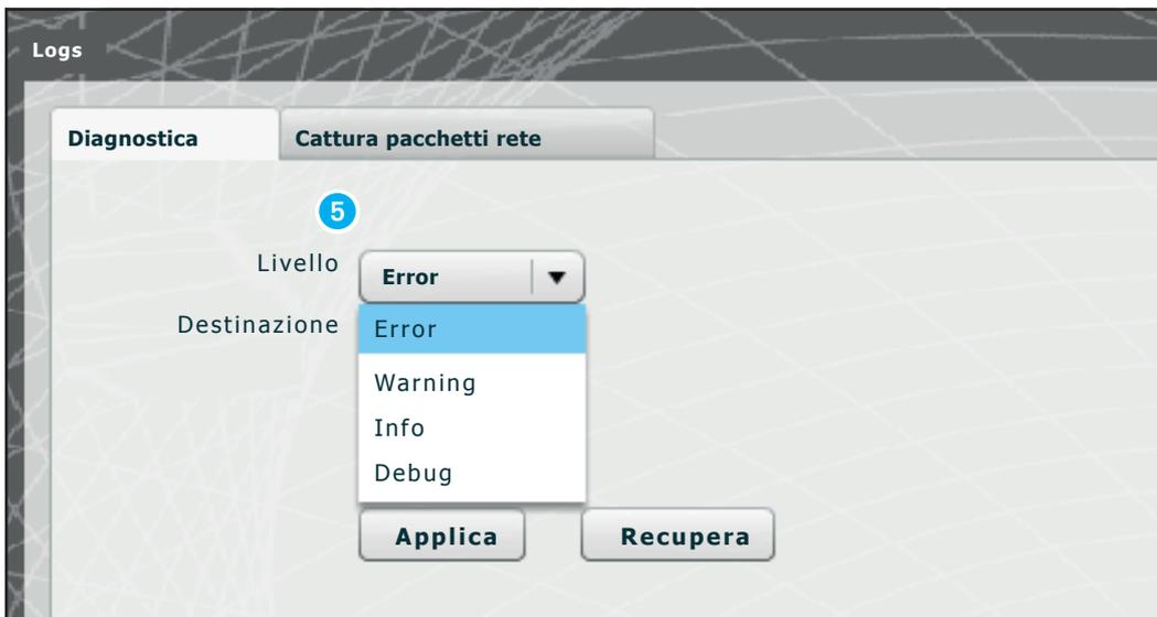
È possibile scegliere il tipo di errore **5** da filtrare, se memorizzare localmente nella memoria del dispositivo **6** oppure su un Syslog specificandone l'indirizzo IP **7** i file di log.
