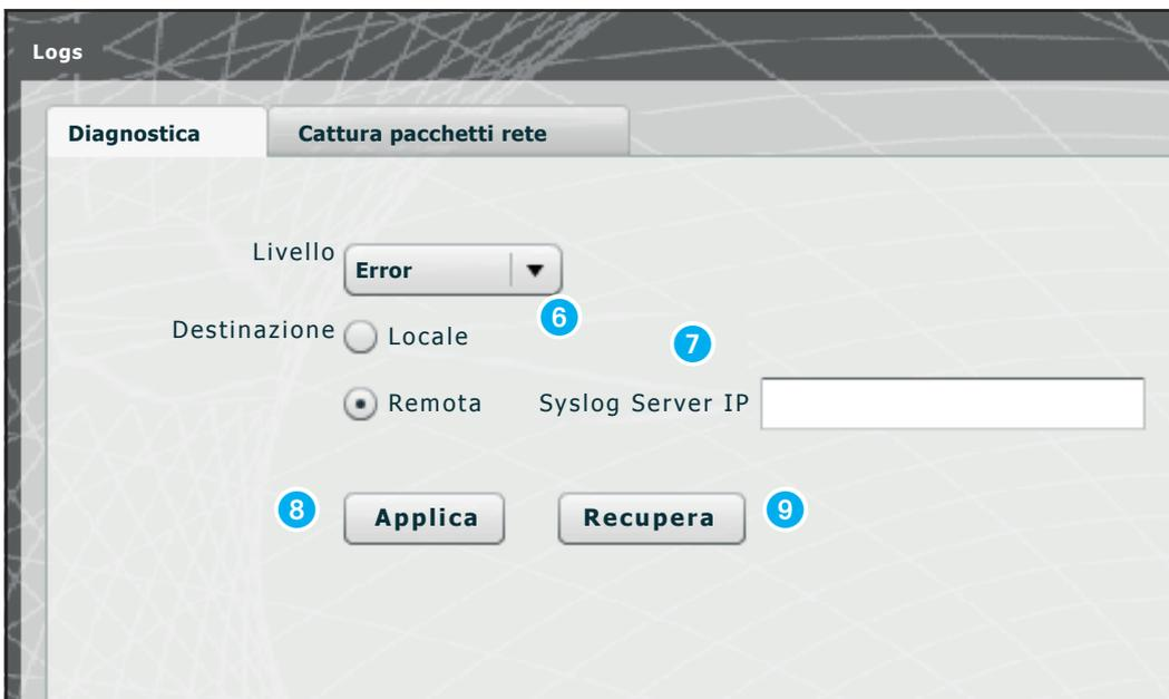
Premendo il pulsante **“Applica”** **8** è possibile applicare la configurazione scelta una volta modificata.
