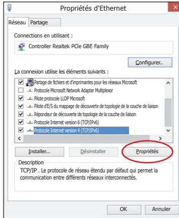
Dans la fenêtre « **État d'Ethernet** » sélectionner « **Propriétés** » ; chercher l'élément « **Protocole Internet version 4 (TCP/IPv6)** » puis cliquer sur « **Propriétés** ».
