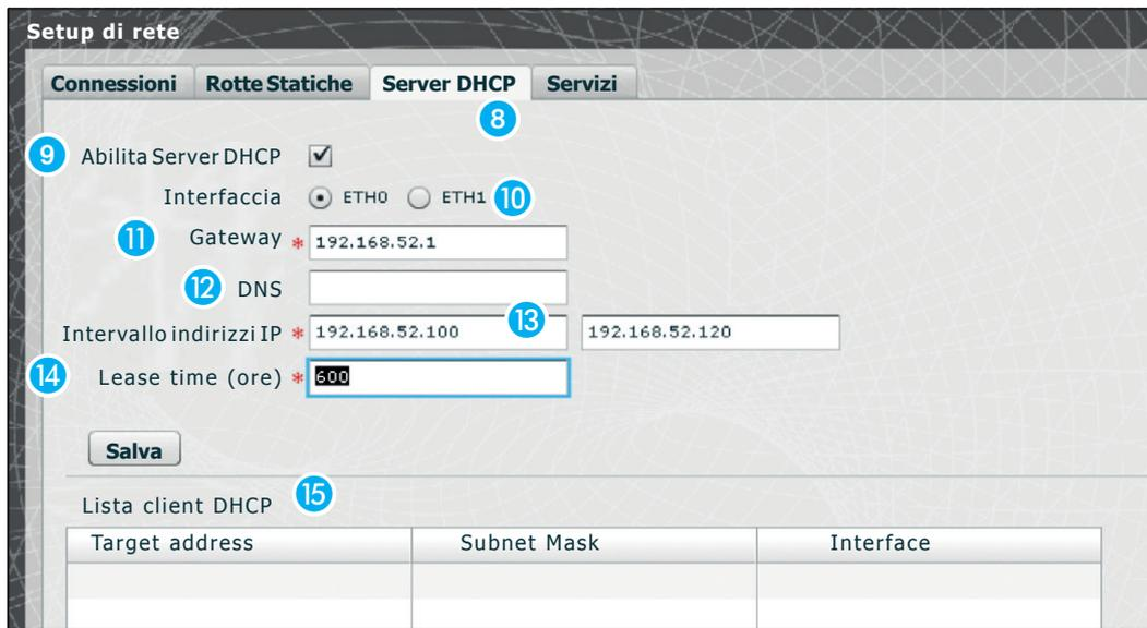
**10 Interfaccia:** consente di scegliere su quale interfaccia attivare il servizio, nel caso di configurazione in Dual Network; nel caso di configurazione in Switch, l'unica interfaccia possibile è la ETH0. Non è possibile attivare il servizio su entrambe le interfacce.
