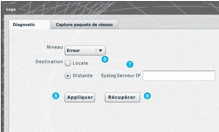
En appuyant sur le bouton « **Appliquer** » **8** il est possible d'appliquer la configuration sélectionnée une fois modifiée.
