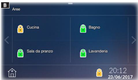
Questa schermata permette di visionare tutte le aree in cui è stato suddiviso l'impianto allarme. Se non si inserisce il codice di autenticazione è possibile solo visionare lo stato delle aree e degli ingressi che le compongono.
