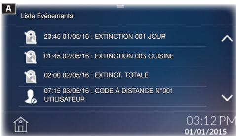
La [LISTE ÉVÉNEM] **A** est structurée de sorte à fournir un tableau précis des événements du système provoqués par des tentatives d'intrusion, de sabotage, des alarmes et des pannes ou tout simplement par des activations/désactivations de la part d'un utilisateur.
