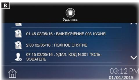
[СПИСОК СОБЫТИЙ] **A** структурирован таким образом, чтобы пользователь имел полное представление обо всех событиях в системе, включая попытки несанкционированного проникновения, взлома, технические неполадки или включения/выключения системы пользователем.
