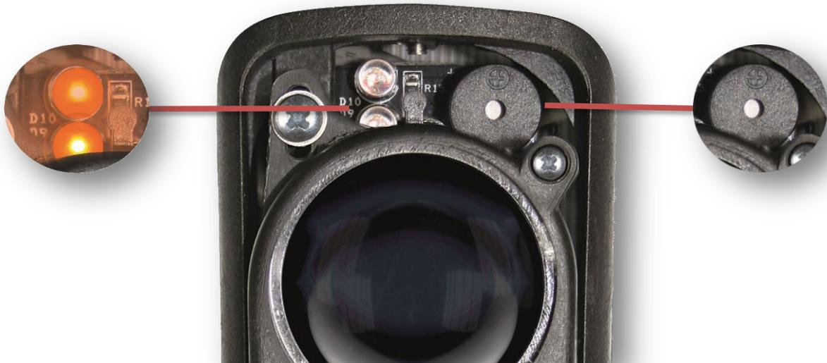
Orientare l'ottica posta nella colonna TX verso quella RX, verticalmente ed orizzontalmente agendo sulle viti di regolazione (orizzontale e verticale) fino a trovare il massimo allineamento. La condizione di massimo allineamento sarà raggiunta quando i led ad alta intensità saranno accesi fissi ed il buzzer emetterà un suono continuo.
