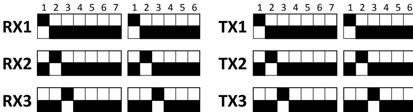
Vanno poi configurate coerentemente le schede madre tramite i banchi a 10 dip (funzionamento 3 raggi)
