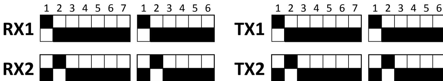
Vanno poi configurate coerentemente le schede madre tramite i banchi a 10 dip (funzionamento 2 raggi)
