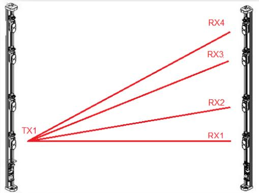
Attivare il TEST di TX1 e verificare il corretto allineamento un'ottica alla volta tramite TEST su RX1 e SUCCESSIVAMENTE su RX2, RX3, RX4 assicurandosi che TX1 sia ancora allineato con RX1.
