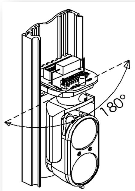
**N.B.: STRINGERE LA VITE DI SBLOCCO SNODO DOPO AVER EFFETTUATO LA REGOLAZIONE**
