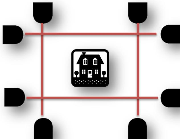
Per un'installazione di barriere sovrapposte posizionare le barriere così come in figura:
