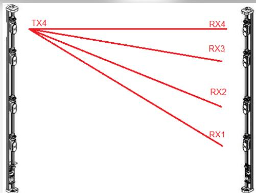
**NB: E' necessaria una distanza minima di almeno 8 metri affinché la prima ottica ricevitore veda l'ultima trasmettitore e viceversa. In particolar modo se viene utilizzata la configurazione con 6 ottiche ricevitori e 6 ottiche trasmettitori.**
