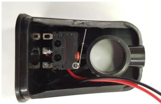
3. Collegare il cavo tamper alla scheda madre facendolo passare all'interno del fissaggio e dell'inserto
