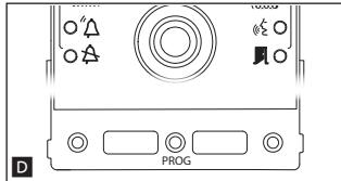
La phase de programmation intercommunicante est signalée par le clignotement des leds de signalisation rouge et jaune **D**.
