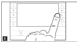
Pour activer le fonctionnement intercommunicant, se positionner sur le poste interne que l'on souhaite programmer et appuyer sur la touche d'appel intercommunicant, avec lequel on souhaite appeler **E**. L'émission d'un signal sonore indiquera que la programmation a été effectuée. Procéder en répétant les mêmes opérations pour tous les autres postes internes à inclure dans le groupe intercommunicant. Pour conclure la programmation, appuyer rapidement sur la touche PROG du poste externe **F**.
