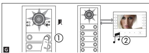
**ПРИМЕЧАНИЕ.** Операция может быть выполнена только с вызывной панели, синий светодиодный индикатор которой выключен(1 В.П. на ). Чтобы изменить вызывную панель, с которой будет осуществляться программирование, необходимо нажать на этой панели одну из клавиш вызова.
