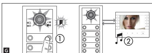
**NOTA.** L'operazione può essere eseguita solo dal posto esterno con led di segnalazione blu **A** spento (1 P.E. in **F**). Per cambiare il posto esterno dal quale eseguire la programmazione delle chiamate, è necessario premere uno dei tasti di chiamata sul posto esterno da cui si vuole programmare.
