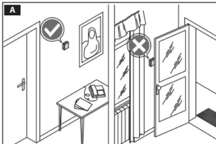
Installare l'apparecchio in posizione idonea a rilevare correttamente la temperatura dell'ambiente, possibilmente in una parete interna, evitando l'installazione in nicchie, dietro a porte, a tende o vicino a sorgenti di calore.
