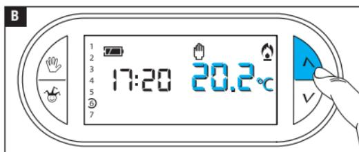
La temperatura impostata verrà mantenuta costante fino all'inserimento di nuove regolazioni o alla selezione di un diverso modo di funzionamento.
