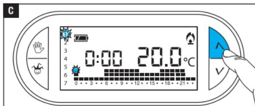
À l'aide des boutons **^ V C** sélectionner la plage de température souhaitée ; appuyer ensuite sur le bouton  $0\div23\triangleright$  pour passer à l'heure suivante et sélectionner quand même la température souhaitée **D**.
