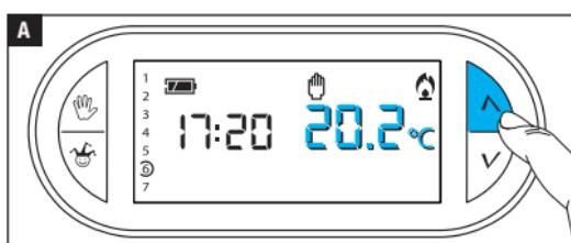
Nel caso si desideri disattivare momentaneamente il controllo automatico della temperatura, è possibile passare al funzionamento MANUALE premendo il pulsante A.
