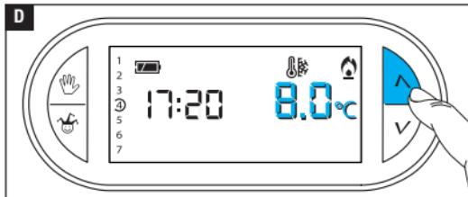
Mit den Tastern **▲▼** wird die niedrigste tolerierte Temperatur für die Temperaturzone eingestellt.
