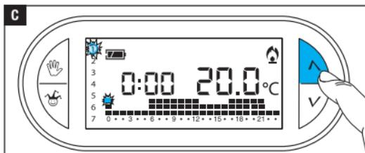
Mit den Tastern **A** **V** **C** den gewünschten Temperaturbereich wählen; danach den Taster **0÷23 ▷** drücken, um auf die nächste Stunde zu wechseln und ebenfalls die Soll-Temperatur wählen **D**.
