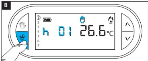
Appuyer sur le bouton et utiliser les boutons et pour configurer les heures d'activation souhaitées **B**.
