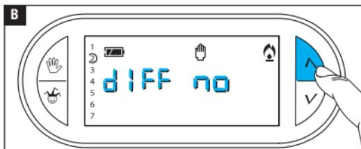
Se servir des boutons  $\wedge \vee$  pour activer/désactiver l'algorithme différentiel **B**.
