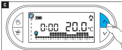
À l'aide des boutons **A**/**V** **C** sélectionner la plage de température souhaitée ; appuyer ensuite sur le bouton **0÷23▷** pour passer à l'heure suivante et sélectionner quand même la température souhaitée **D**.
