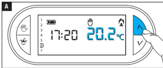
Pour désactiver momentanément le contrôle automatique de la température, il est possible de passer au fonctionnement MANUEL en appuyant sur le bouton A.
