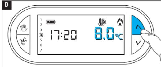
Les boutons **^**/**V** permettent de configurer la température ambiante minimum tolérée pour la zone thermique.
