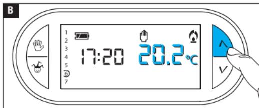
Auf dem Display wird neben der aktuellen Uhrzeit die voreingestellte manuelle Soll-Temperatur (20°C) angezeigt.
