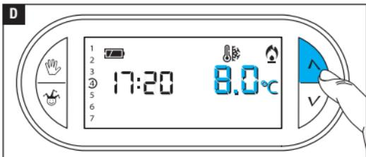
Mit den Tastern **^V** wird die niedrigste tolerierte Temperatur für die Temperaturzone eingestellt.
