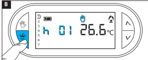
Auf den Taster drücken und mit den Tastern die Dauer der Aktivierung in Stunden einstellen **B**.
