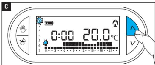
Mit den Tastern **▲** **▼** **C** den gewünschten Temperaturbereich wählen; danach den Taster **0÷23 ▷** drücken, um auf die nächste Stunde zu wechseln und ebenfalls die Soll-Temperatur wählen **D**.
