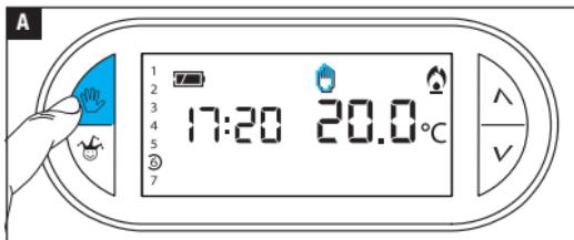
Wenn die automatische Temperatursteuerung momentan deaktiviert werden soll, kann man mit dem Taster auf MANUELLEN Betrieb umschalten A.
