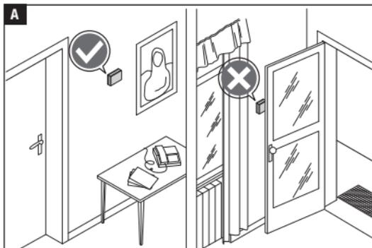
Installieren Sie das Gerät an einer geeigneten Stelle für das Messen der Raumtemperatur, möglichst an einer Innenwand und nicht in Nischen, hinter Türen oder Gardinen oder in der Nähe von Wärmequellen.
