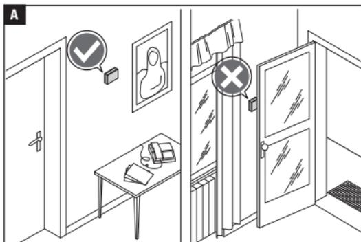
Installer l'appareil dans une position lui permettant de détecter correctement la température ambiante, si possible dans un mur interne, en évitant l'installation dans des ouvertures, derrière des portes, des rideaux ou près de sources de chaleur.
