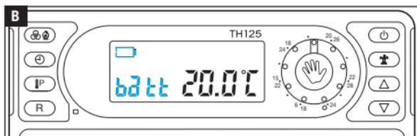
Wenn auf dem Display die Anzeigen **batt** +
