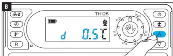
Stellen Sie mit den Tasten  $\Delta$ / $\nabla$  den gewünschten Wert des Differenzials ein (von  $\pm 0,1\text{ }^{\circ}\text{C}$  bis  $\pm 0,9\text{ }^{\circ}\text{C}$ ).
