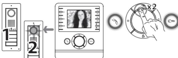
Для окончания просмотра два раза нажмите клавишу или дождитесь автоматического отключения (макс. 60с).
