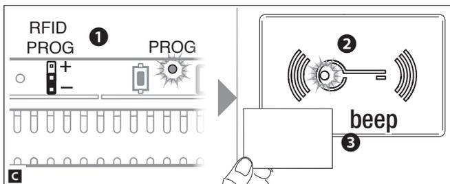
Per rimuovere i badge, posizionare il jumper RFID PROG dell'alimentatore in posizione "-" **1**. Quando il LED rosso del modulo MTMR-FID inizia a lampeggiare lentamente **2**, strisciare due volte i badge da rimuovere vicino al lettore. Un beep confermerà la corretta procedura **3**.
