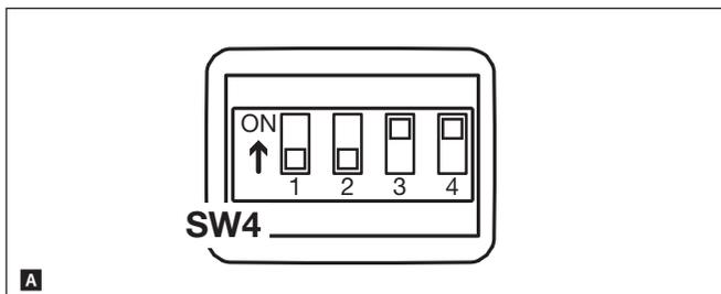
Для восстановления заводских настроек модуля MTMRFID необходимо отключить электропитание, установить DIP1 и DIP2 переключателя SW4 в положение "ВКЛ." и снова подать напряжение на модуль **A**.
