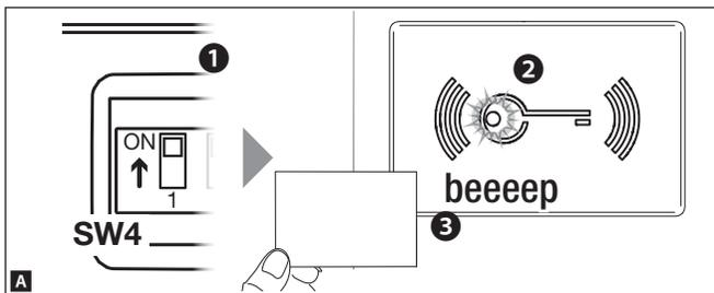
Для присвоения проксимити-карт выбранному реле установите DIP1 в положение ВКЛ. **1**. Когда красный светодиодный индикатор на модуле MTMRFID медленно мигает **2**, проведите картой возле считывателя **3**.
