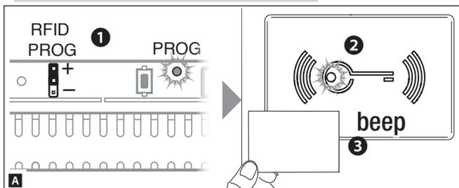
Pour associer les badges, positionner le cavalier RFID PROG du bloc d'alimentation sur « + » **1**.
