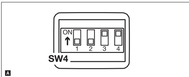
Pour réinitialiser le module MTMRFID aux conditions d'usine, mettre hors tension, positionner les micro-interrupteurs DIP1 et DIP2 de l'interrupteur SW4 sur ON et remettre le module sous tension **A**.
