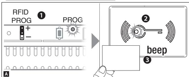
Per associare i badge, posizionare il jumper RFID PROG dell'alimentatore in posizione "+" **1**.
