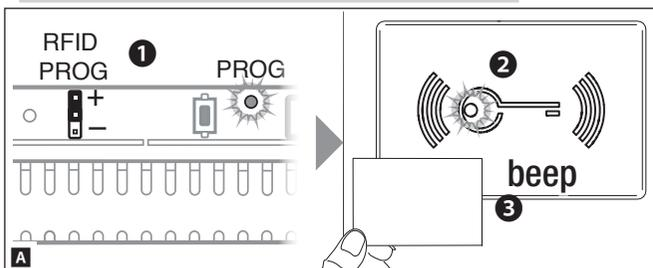
Для присвоения проксимити-карты установите переключку RFID PROG контроллера в положение "+" **1**. Когда красный светодиодный индикатор на модуле MTMRFID быстро замигает **2**, проведите добавляемой проксимити-картой возле считывателя **3**. Звуковой сигнал подтвердит успешное присвоение.
