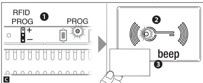
Для удаления проксимити-карты установите переключку RFID PROG контроллера в положение "-" **1**. Когда красный светодиодный индикатор на модуле MTMRFID медленно замигает **2**, проведите два раза все удаляемые карты вблизи считывателя. Звуковой сигнал подтвердит правильное исполнение процедуры **3**.
