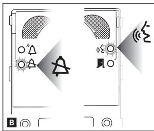
Pour associer les badges, positionner le cavalier RFID PROG du bloc d'alimentation sur « + ». La led PROG du bloc d'alimentation et les leds et clignoteront rapidement **A B**.
