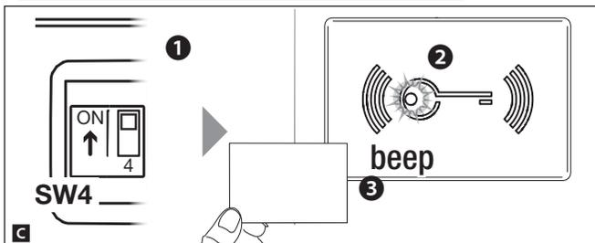
Для удаления утерянных проксимити-карт установите DIP4 в положение "ВКЛ." **1**. Когда красный светодиодный индикатор на модуле MTMRFID загорится ровным светом **2**, проведите все предварительно запомненные проксимити-карты вблизи считывателя.
