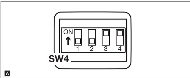
Per ripristinare il modulo MTMRFID alle condizioni di fabbrica è necessario togliere l'alimentazione, posizionare il DIP1 e DIP2 dello SWITCH SW4 in ON e alimentare nuovamente il modulo **A**. Dopo 5 secondi il modulo si riavvia ed un tono confermerà l'avvenuto ripristino.
