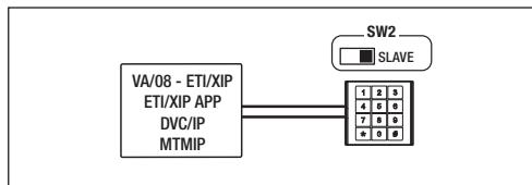
L'invio del codice identificativo (ID) del dispositivo avviene digitando il codice **\*0000#**.
