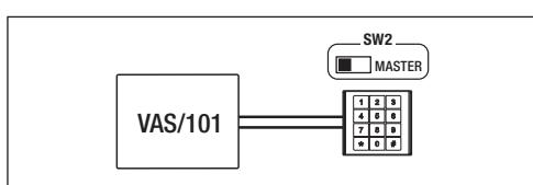
Pour entrer dans le menu de programmation, saisir le code Master (par défaut 0000) et appuyer sur **\*#\***. La phase de programmation est signalée par l'allumage de la bande lumineuse rouge présente au bas du clavier.
