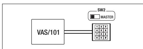
Для доступа к программированию введите мастер-код (по умолчанию: 0000) и нажмите **\* #**. При входе в режим программирования загорается светящаяся красная полоска в нижней части кнопочной панели.
